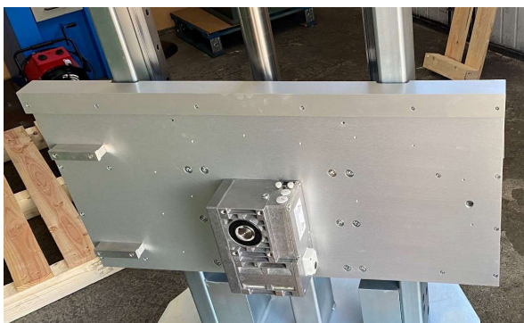
Rückansicht ohne Schaltschrank, mit 220V Antriebsgetriebemotor Rear view without electrical cabinett, showing 220V drive motor
