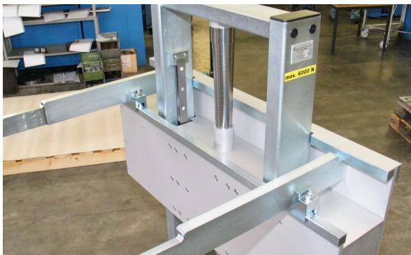
Ansicht Edelstahl-Teleskopfeder, Linearfüh- rungen und verstellbaren Gabelkörpern View of stainless steel telescopic cover, linear rails and adjustable fork bodies.
