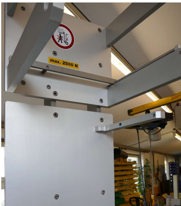
Sonderausführung für 250Kg Last und 1800mm Hubhöhe mit Einhängesicherung Custom-build, 250Kg load capacity and 1.800mm lifting height incl. safety locks
