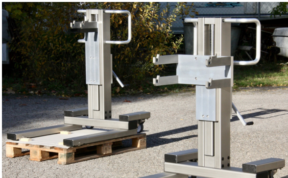
Hubwagen mit Gabeln zur Aufnahme von Matritzen, Edelstahl, Food / Pharma Mobile lifts with forks to lift tools and dies, stainless steel, Food / Pharma
