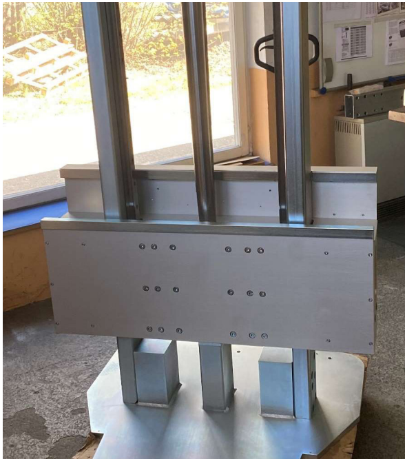
Stationäre Hubeinheit, 450Kg Last, elek- trisch betrieben, Hub 1135mm, Hubhöhe 2000mm; Bild ohne Gabeln. Anwendung: Impfstoff-Forschung Stationary lifting unit, 450Kg load, electri- cally operated, 1135mm stroke, lifting height 2000mm. Picture without forks. Application: R&D Vaccinations
