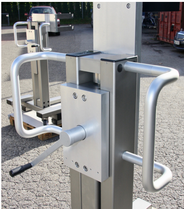
Rückansicht mit Handkurbel, selbstthem- mendes Schneckengetriebe mit Zahnstan- genantrieb und Edelstahl Teleskopfeder Rear view showing crank, self-locking gear set and stainless steel telescopic cover
