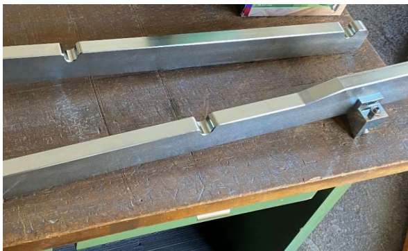
Ein- und aushängbare Gabeln Removable forks of above unit
