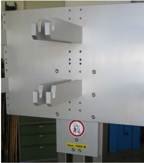
Gabelplatte mit 4 Gabelsätzen Forkplate with 4 sets of forks
