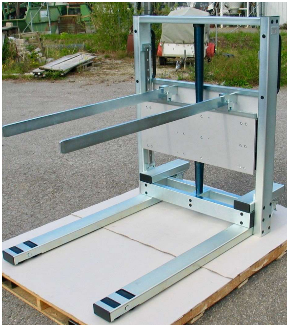
Ausführung für 650Kg Last, Gabeln ein- aus- hängbar, seitlich verschiebbar und in der Höhe einzeln einstellbar. Anwendung in der Pharma-Verpackungsindustrie Mobile lift load capacity 650Kg, forks remo- vable, sidewise and height adjustable. Appli- cation Pharma and Packaging indsutries.
